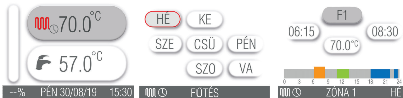
Beépített időprogram a fűtőkörök számára
