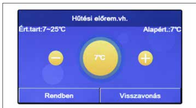
ábra 26 "Hűtés előrem. víz." képernyőoldal
