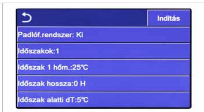
ábra 41 "Padlófűtés felfűtés" választó képernyő
