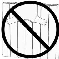
Le radiateur doit être fixé au mur au moyen du support de fixation fourni.
