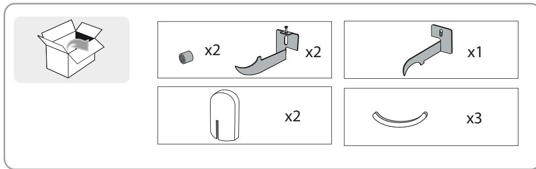
**WARNUNG:** Schrauben und Dübel sind nicht im Lieferumfang der Verpackung enthalten. Verwenden Sie daher Schrauben und Dübel, die für die Art des Wandmaterials geeignet sind, an dem der Heizkörper befestigt werden soll. Der Dübel muss einen Durchmesser von 10 mm haben, die Schraube muss eine Länge von 60 mm, einen Durchmesser von 7,5 mm und einen Sechskantkopf haben.
